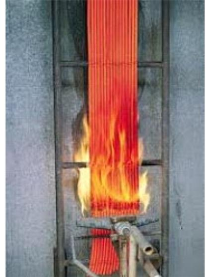
EN 60332-3-10:2009/BS EN 60332-3-10:2009/IEC 60332-3-10 ed1.1/DIN EN 60332-3-10:2009/ VDE 0482-332-3-10:2010-08该标准试验是在着火条件下对电缆常用的测试方法。该试验是在着火条件下，电力电缆和光纤电缆的试验。第3-10部分是对垂直安装的成束电缆的垂直火焰蔓延试验。
